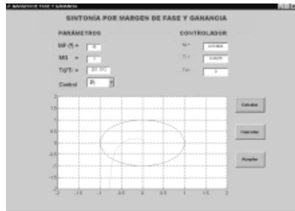
Figura 14: Diseño para (3) con MF=45° y MG =3
