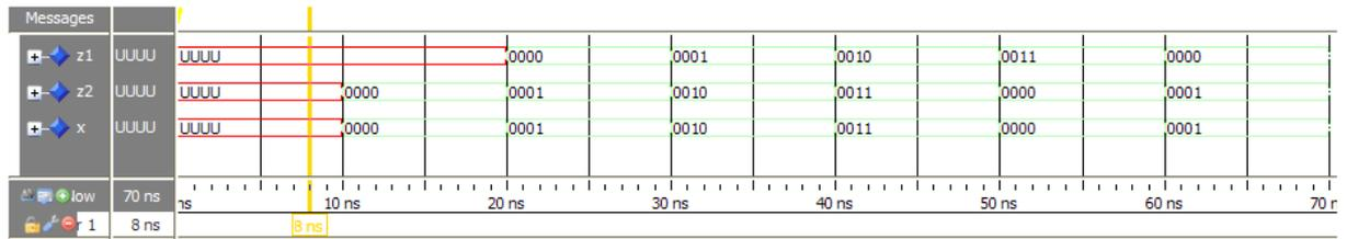
El bloque **process** se ejecuta indefinidamente, ya que no existe ninguna sentencia **wait** que pare su ejecución. Por tanto, el bucle que existe en el interior de este bloque se ejecuta continuamente tomando  $i$  los valores 0, 1, 2 o 3.
