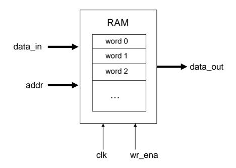
La señal data\_in se almacena en la posición indicada por addr cuando la señal wr\_ena está a '1' y la señal clk está en el flanco de subida.
