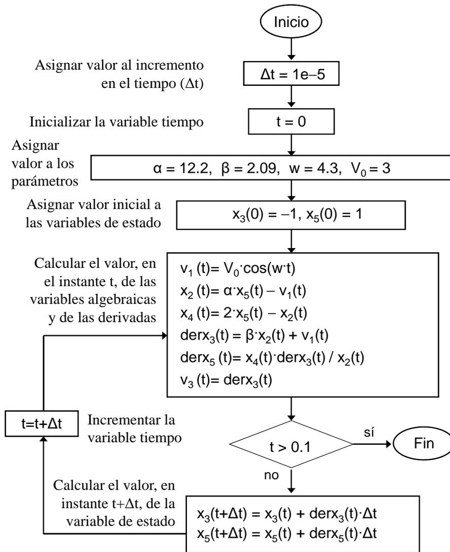
Figura 1: Diagrama de flujo de la simulación.
