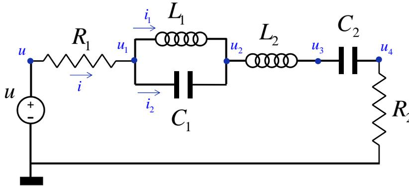
**Figura 3:** Nombres de los voltajes en los nodos y las corrientes.
