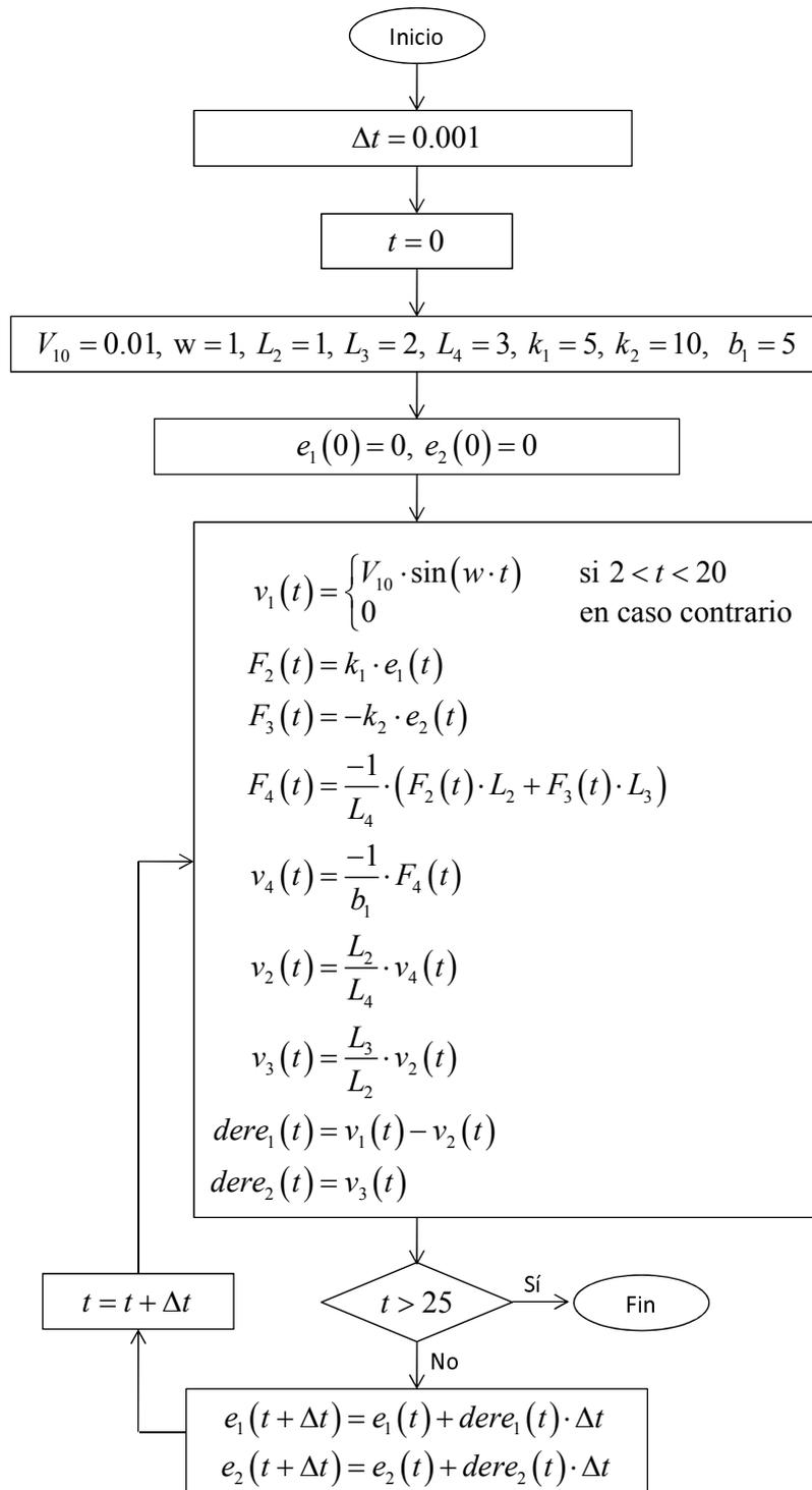
Figura 1.1: Algoritmo para la simulación del sistema mecánico.
