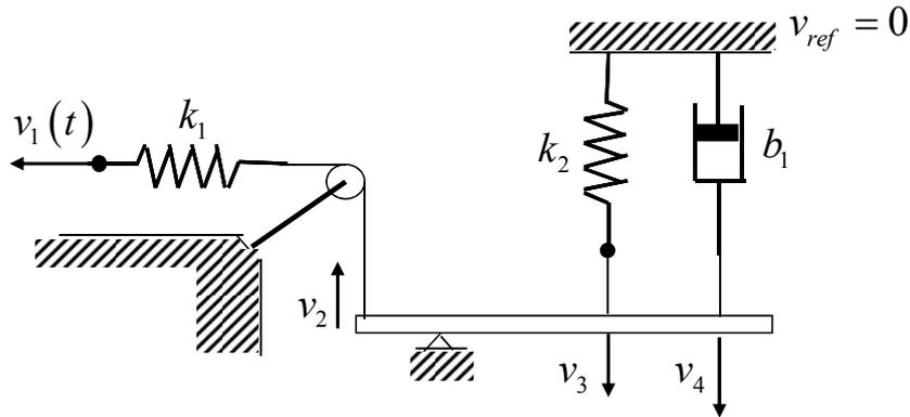
Se supone que las masas de la polea y la palanca son despreciables, y que los muelles y el amortiguador se comportan linealmente. La velocidad  $v_1$  es una función conocida del tiempo.
