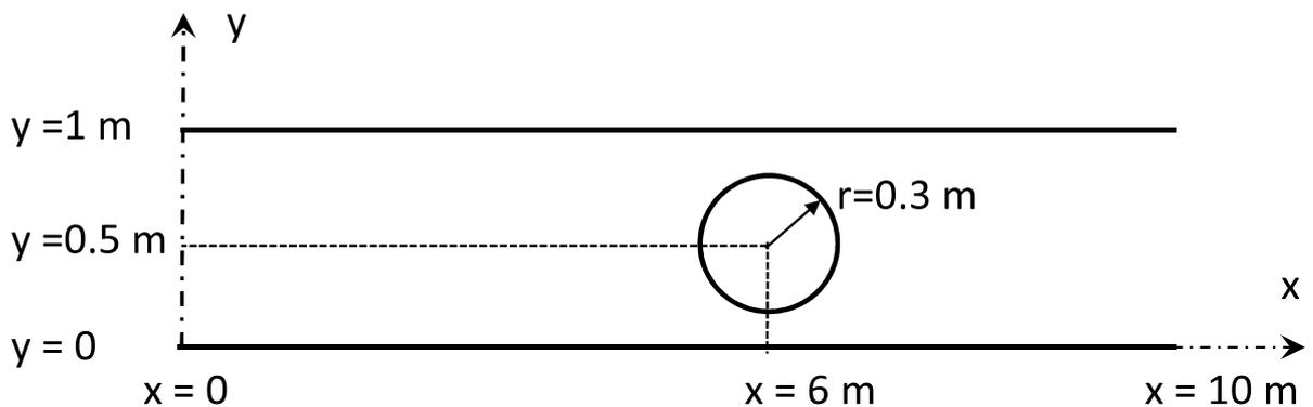
Los electrodos están situados en  $y = 0$  e  $y = 1 \text{ m}$ , y tienen una longitud de 10 m, extendiéndose desde  $x = 0$  a  $x = 10 \text{ m}$ . Suponemos que no existen efectos debidos a los bordes y que el campo eléctrico tanto en  $x = 0$  como en  $x = 10 \text{ m}$  está dirigido verticalmente.
