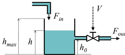
La válvula puede encontrarse en dos fases: abierta y cerrada. En el primer caso (abierta) permite el paso de líquido y en el segundo (cerrada) lo impide. El valor de la variable Booleana  $V$  determina si la válvula está abierta ( $V=true$ ) o cerrada ( $V=false$ ). La fase de la válvula cambia cada  $T = 0.5$  segundos, estando inicialmente cerrada.
