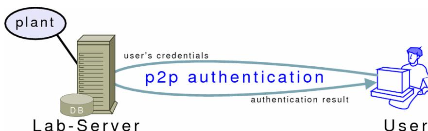
**Figura 12.** Esquema de autenticación punto a punto del sistema de reservas.
