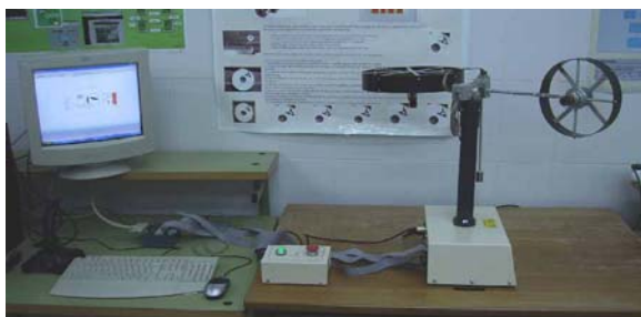
Fig. 5: Twin Rotor MIMO System 33-220 de la casa Feedback
